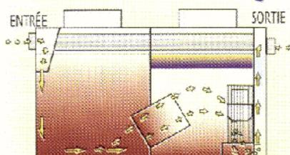
Le flux traverse le filtre de bas en haut. Débarrassée de ses hydrocarbures, l'eau s'évacue par un orifice situé le plus bas possible évitant ainsi le phénomène de "lessivage".
