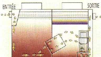
Le flux traverse le filtre de bas en haut. Débarrassée de ses hydrocarbures, l'eau s'évacue par un orifice situé le plus bas possible évitant ainsi le phénomène de "lessivage".
