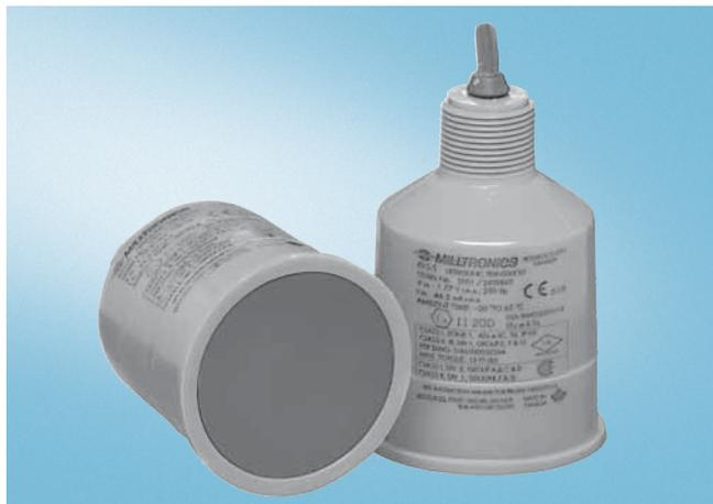
Le transducteur ultrasonique Echomax<sup>®</sup> XRS-5 garantit la mesure de niveau en continu de liquides et de boues liquides. Solution fiable pour les stations de relèvement étroites, les canaux, les déversoirs et les lits filtrants, il est doté d'un angle d'émission réduit (10°) et d'une face émettrice en caoutchouc CSM.
